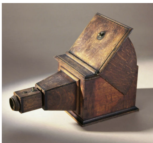
FIG. 1.6 – Une caméra obscura.
