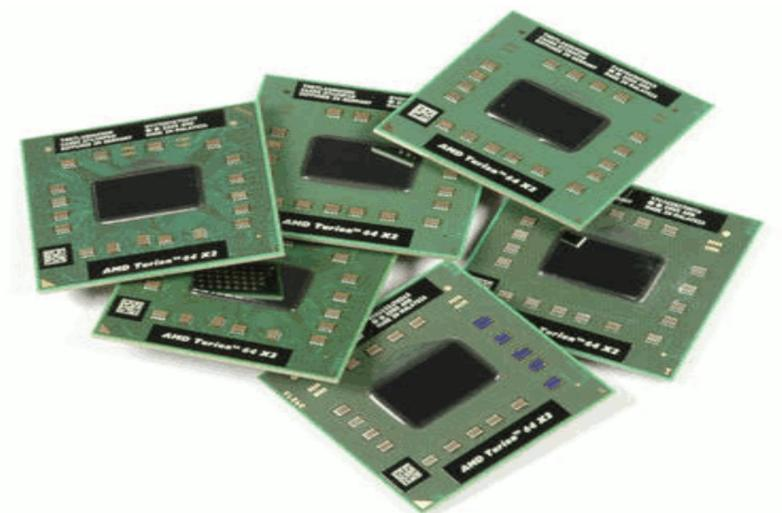
**FIG. 3.18** – Différents types de microprocesseurs simple cœur et multicœurs
