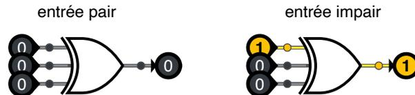
Pour détecter si un nombre d'entrées est pair, il suffit d'ajouter un NON à la sortie du OU-X. On appelle ce circuit un NON-OU-X.
