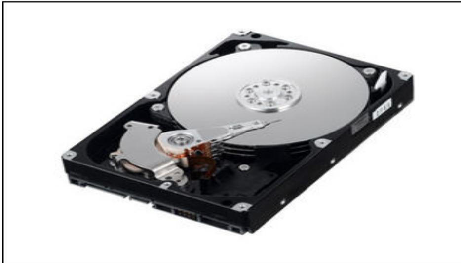
**FIG. 3.15** – Disque dur mécanique
